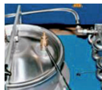
Zawór bezpieczeństwa w pokrywie zbiornika
