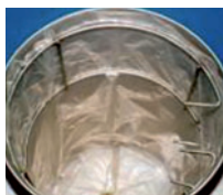
Brak nagrzewnicy parowej w podgrzewanym zbiorniku
