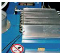
Kondensator ze stali szlachetnej chłodzony powietrzem
